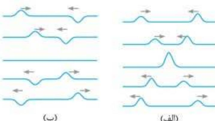
در شکل (الف) دو تپ هنگام همپوشانی، تپ بزرگ‌تری را ایجاد می‌کنند که به آن تداخل سازنده می‌گوییم. در شکل (ب) دو تپ هنگام همپوشانی، اثر همدیگر را حذف می‌کنند که به آن تداخل ویرانگر می‌گوییم.
