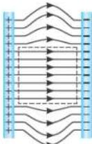
برای ایجاد میدان الکتریکی یکنواخت باید بارهای همان اندازه و غیر همانم با دو صفحه رسانایی تخت باهم داده شود. این کار با وصل کردن دو صفحه تخت به دو سر یک مولد انجام می شود. در فضای درون دو صفحه دور از لبه ها (که در شکل به صورت خطچین نشان داده شده است) میدان الکتریکی یکنواختی ایجاد می شود.
