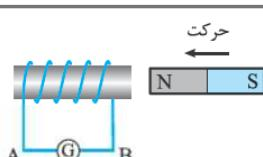
(الف) با ذکر دلیل تعیین کنید جهت جریان القایی در سیم AB به سمت راست است یا چپ؟
