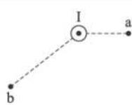
بردار میدان مغناطیسی ناشی از یک سیم بسیار بلند حامل جریان (برون‌سو) را در نقاط نشان داده شده مشخص کنید.
